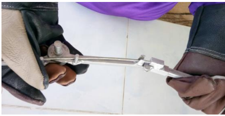
ภาพที่ 7 การตัดลวดเหล็กขนาด 3 มิลลิเมตร
