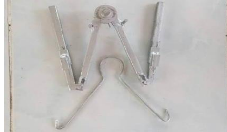
ภาพที่ 10 รูปแบบลวดเหล็ก แบบยึดท่อ PVC
