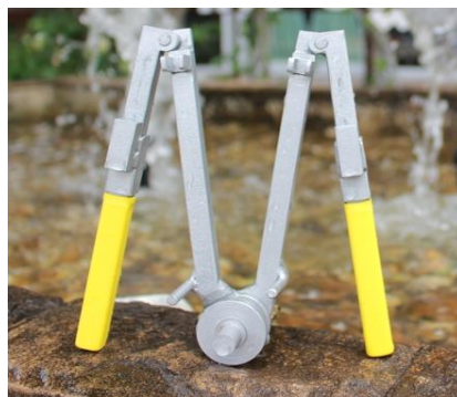
ภาพที่ 6 เครื่องมือตัดลวดสำหรับยึดสายดิน
