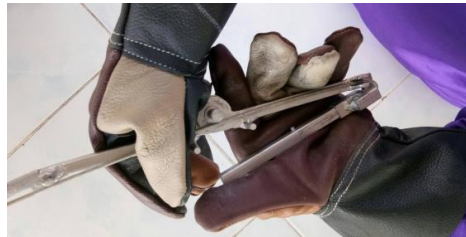
ภาพที่ 7 การตัดลวดเหล็กขนาด 3 มิลลิเมตร
