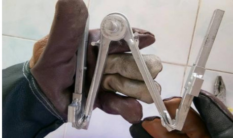
ภาพที่ 10 รูปแบบลวดเหล็ก แบบยึดท่อ PVC
