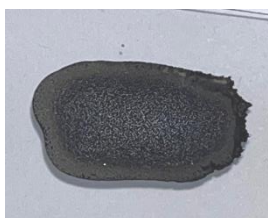
(a) MWCNTs : SiC : Cs (25mg) 1 : 1 : 1
