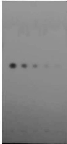
ภาพที่ 4 สารมาตรฐาน Mallorepine ที่ความเข้มข้น 10, 5, 2.5, 1.25, 0.625 mg/ml
