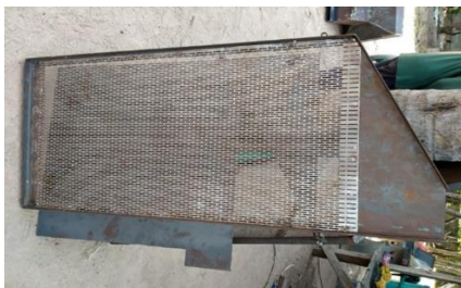
ภาพที่ 3 ตะแกรงคัดสิ่งเจือปนขนาดใหญ่ชั้นบน และ ตะแกรงคัดสิ่งเจือปนขนาดเล็กชั้นล่าง
