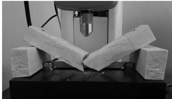
ภาพที่ 2 หัวเจาะออกแรงกดสูงสุดที่หินอ่อนขึ้นทดสอบจะสามารถต้านทานได้
