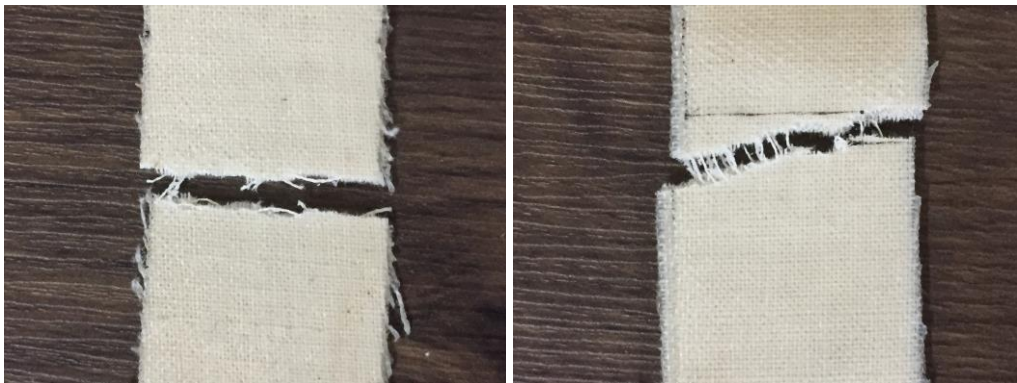
ภาพที่ 9 แสดงลักษณะการฉีกขาดคอมโพสิตผ้าฝ้ายแผ่นเดียว 4 ชั้น ในทิศทางการจัดเรียงตัวของเส้นด้ายพุ่งแบบ Unidirectional, Cross-Ply และ Angle-Ply (A1, A2, A3, A4 และ A5)
