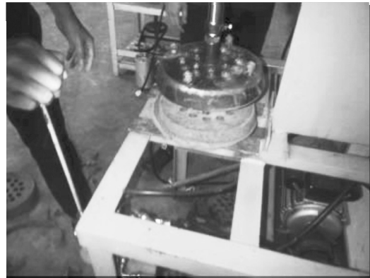
ภาพที่ 8 การวางแผ่นรังผึ้งไว้บนแผ่นรองชิ้นงาน (Die) ภาพที่ 9 การยกหัวปั๊ม (Punch) ขึ้นหลังจากกดเจาะ ผลการวิจัย
