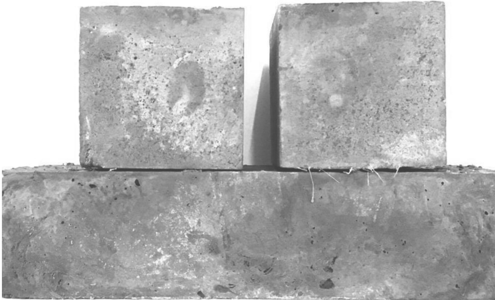
ภาพที่ 2 ตัวอย่างไฟเบอร์ซีเมนต์ที่ได้จากการหล่อแบบขนาด 5x5x5 เซนติเมตร และขนาด 4x16x4 เซนติเมตร
