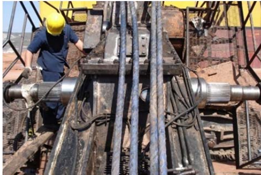
ภาพที่ 2 เพลลาขับเคลื่อนปั๊มกีของรถชุดไฟฟ้าตีนจะขาบ
