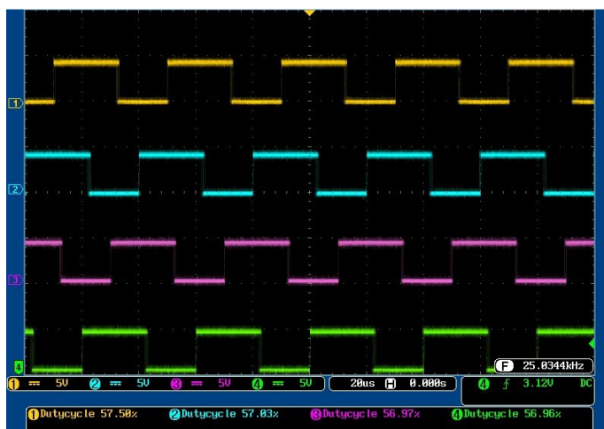
ภาพที่ 6 สัญญาณการขับเคลื่อนที่มีการเหลื่อมเฟสกัน 90 องศาของวงจรทอน-ทบแบบขนานแบบเหลื่อมเฟสชนิด 4 เฟสที่มีการป้อนกลับแรงดันแบบวงรอบปิดด้วยตัวควบคุมชนิดพีไอ
