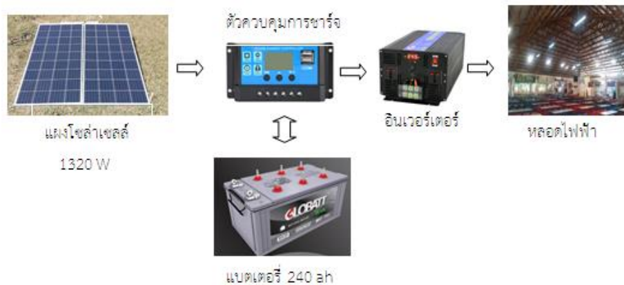
ภาพที่ 7 การใช้พลังงานแสงอาทิตย์มาใช้ร่วมกับระบบควบคุมแสงอัตโนมัติสำหรับหลอดไฟฟ้า
