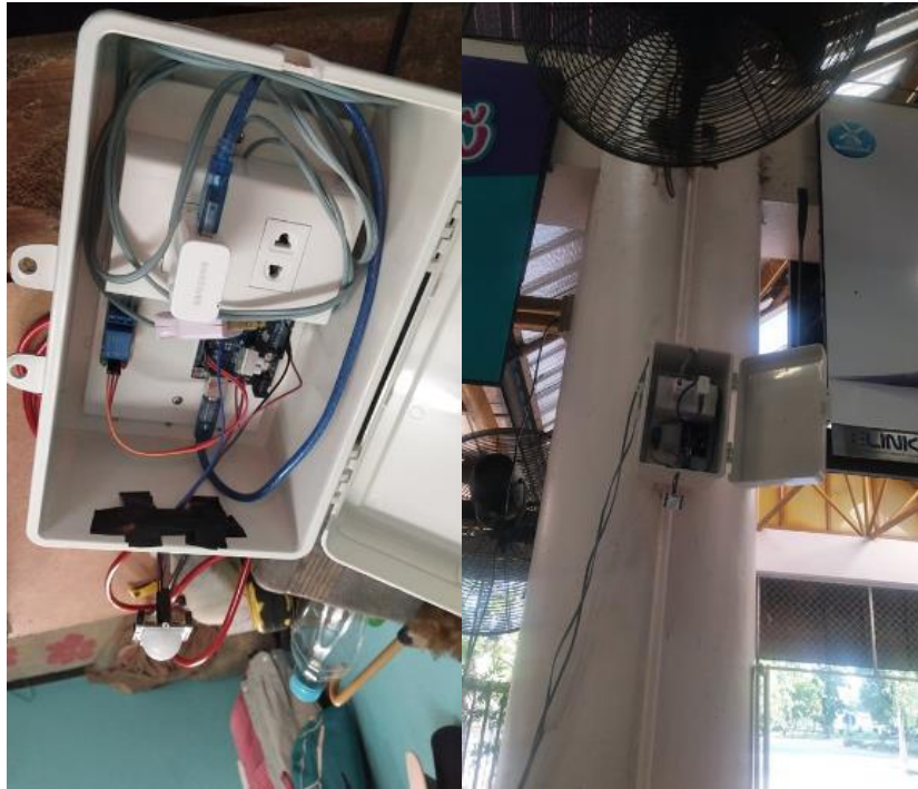
ภาพที่ 4 ต้นแบบระบบควบคุมการเคลื่อนไหวอัตโนมัติสำหรับลมไอน้ำและหลอดไฟฟ้า
