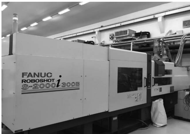
ภาพที่ 2 การทดลองฉีดขึ้นรูปแก้วน้ำ 22 ออนซ์ ด้วยเครื่องฉีด FANUC ROBOTSHOT S-2000i300B
