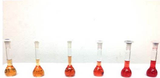
ภาพที่ 4 สีของสารละลายมาตรฐานแคลเซียม (1.56-50.00 mg/L) สำหรับตรวจสอบด้วยเทคนิคคัลเลอร์ิเมทรี
