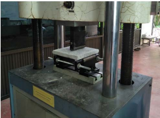
ภาพที่ 3 การทดสอบกำลังต้านทานแรงดัดตามขวางของแผ่นคอนกรีตปูพื้นทางเท้าผสมผงหินอ่อน
