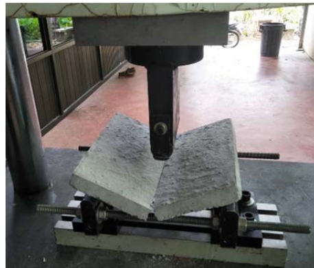
ภาพที่ 3 การทดสอบกำลังต้านทานแรงดัดตามขวางของแผ่นคอนกรีตปูพื้นทางเท้าผสมผงหินอ่อน
