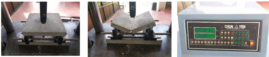
ภาพที่ 4 การทดสอบกำลังต้านทานแรงดัดตามขวาง
