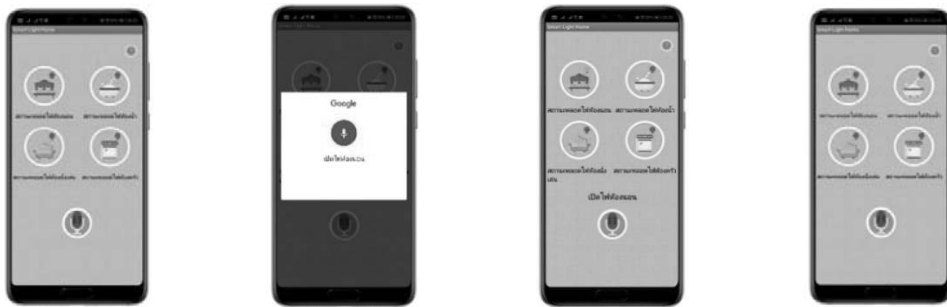
(ก) หน้าต่างโปรแกรม (ข) แสดงคำสั่งที่ได้จากเว็บไซต์พีซีไอโอ (ค) แสดงสถานะเปิดไฟห้องนอน (ง) แสดงสถานะปิดไฟห้องนอน
