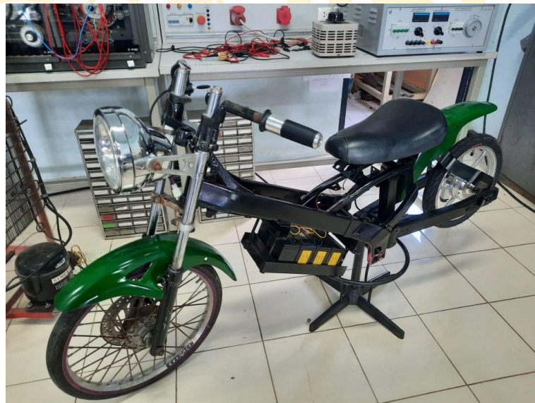
ภาพที่ 9 รถจักรยานไฟฟ้าขับเคลื่อนด้วยมอเตอร์ไฟฟ้ากระแสตรงชนิดไร้แปรงถ่าน
