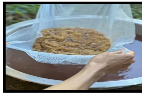
ภาพที่ 4 ขั้นตอนการนำวัตถุดิบมาต้มและแยกกากวัตถุดิบออก และกรอกสีที่สกัดได้ ด้วยผ้าขาวบาง
