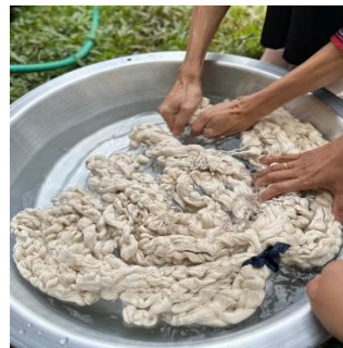
ภาพที่ 1 ขั้นตอนการล้างไข่ออกจากฝ้ายด้วยน้ำเปล่าและนำไปต้มกับน้ำผสมผงซักฟอก
