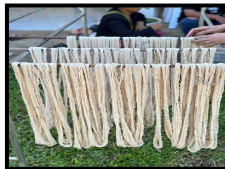
ภาพที่ 2 ขั้นตอนการล้างฝ้ายหลังจากต้มกับผงซักฟอก และนำไปตากลม
