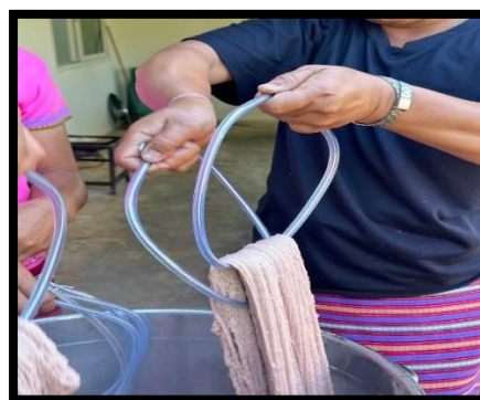
ภาพที่ 6 นำฝ้ายจุ่มสีทิ้งไว้ประมาณ 30 นาที โดยนำเส้นฝ้ายขึ้นมากลับบนลงล่างและล่างขึ้นบน ทุก ๆ 5 นาที
