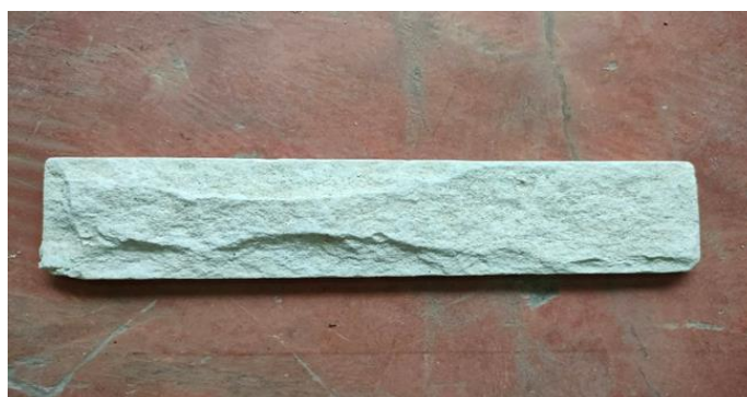
ภาพที่ 7 กระเบื้องหินทรายเทียมจากผงหินอ่อนที่ขึ้นรูปจริง
