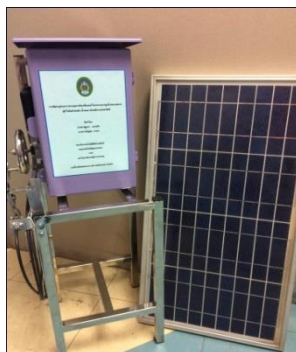
ภาพที่ 2 ระบบการควบคุมการดับเครื่องยนต์กระบวนกรสูบน้ำของเกษตรกรผู้ทำไร่มันสำปะหลังระบบน้ำหยดด้วยพลังงานแสงอาทิตย์
