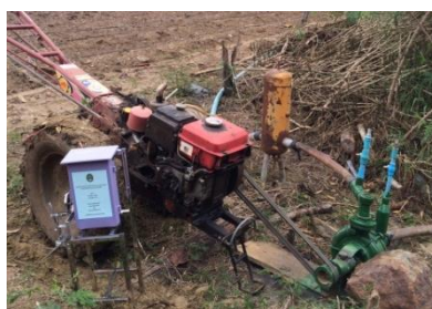
ภาพที่ 3 การติดตั้งระบบการควบคุมการดับเครื่องยนต์กระบวนกรสูบน้ำของเกษตรกรผู้ทำไร่มันสำปะหลังระบบน้ำหยดด้วยพลังงานแสงอาทิตย์
