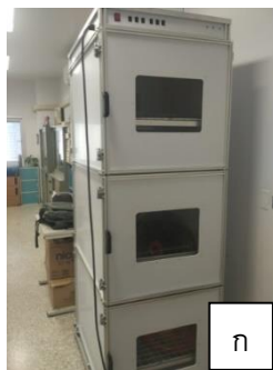
ภาพที่ 9 ตู้อนุบาลกล้วยไข่กำแพงเพชร แสดงลักษณะโครงสร้างภายนอก (ก) และภายในตู้ (ข)
