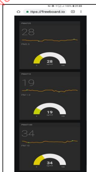
ภาพที่ 12 การแสดงผลค่าเซนเซอร์ทั้งหมด แบบ GUI บน Dash Board ของระบบคลาวด์ https://freeboard.io ผ่านอุปกรณ์โทรศัพท์เคลื่อนที่ (ที่มา: ศิลป์ณรงค์ ฉวีพัฒน์, 2561)
