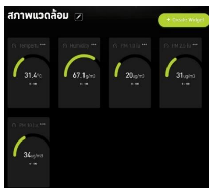
ภาพที่ 9 การแสดงผลค่าเซนเซอร์ทั้งหมด แบบ GUI บน Dash Board ของระบบคลาวด์ aismagellan (ที่มา: ศิลป์ณรงค์ ฉวีพัฒน์, 2561)
