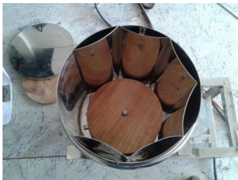
ภาพที่ 4 การติดตั้งไม้เข้ากลบแกนมอเตอร์
