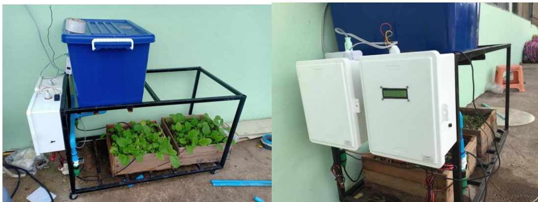
ภาพที่ 3 ต้นแบบระบบรดน้ำแบบน้ำหยดควบคุมด้วยสมาร์ทโฟน
