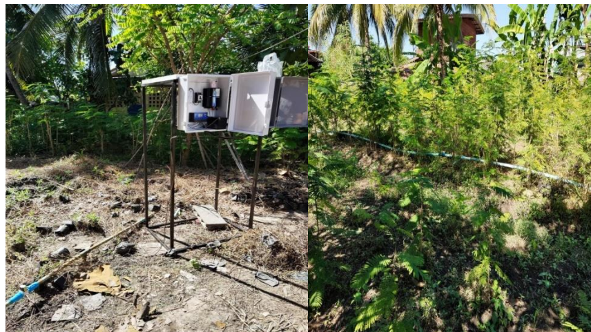
ภาพที่ 7 ต้นแบบระบบรดน้ำเซอมพลังงานแสงอาทิตย์โดยควบคุมด้วยสมาร์โฟน
