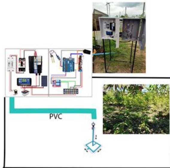
ภาพที่ 2 โครงสร้างระบบรดน้ำชอมพลังงานแสงอาทิตย์โดยควบคุมด้วยเซ็นเซอร์วัดความชื้นในดิน
