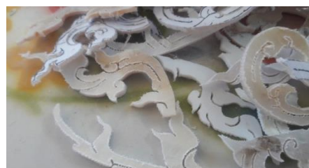
(ฉ) ตีคลายไทยเปลือกหอยกาบ (ช) ลายเปลือกหอยกาบที่ผ่านการฉลุลาย ภาพที่ 3 แสดงการหาประสิทธิภาพการทำงานของเครื่องฉลุลายเปลือกหอยกาบ
