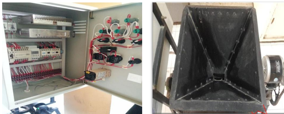
ภาพที่ 6 ตัวถังตวงน้ำหนักแบบอัตโนมัติสำหรับบรรจุภัณฑ์ข้าวไรเบอร์รี่
