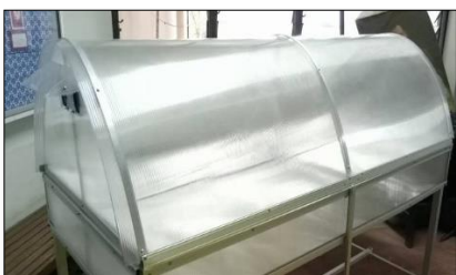
ภาพที่ 3 หลังคาพาราโบลาปิดคลุมด้วยแผ่นโพลีคาร์บอเนต
