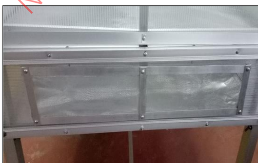
ภาพที่ 9 ช่องสำหรับให้อากาศเข้าข้างในตู้อบ
